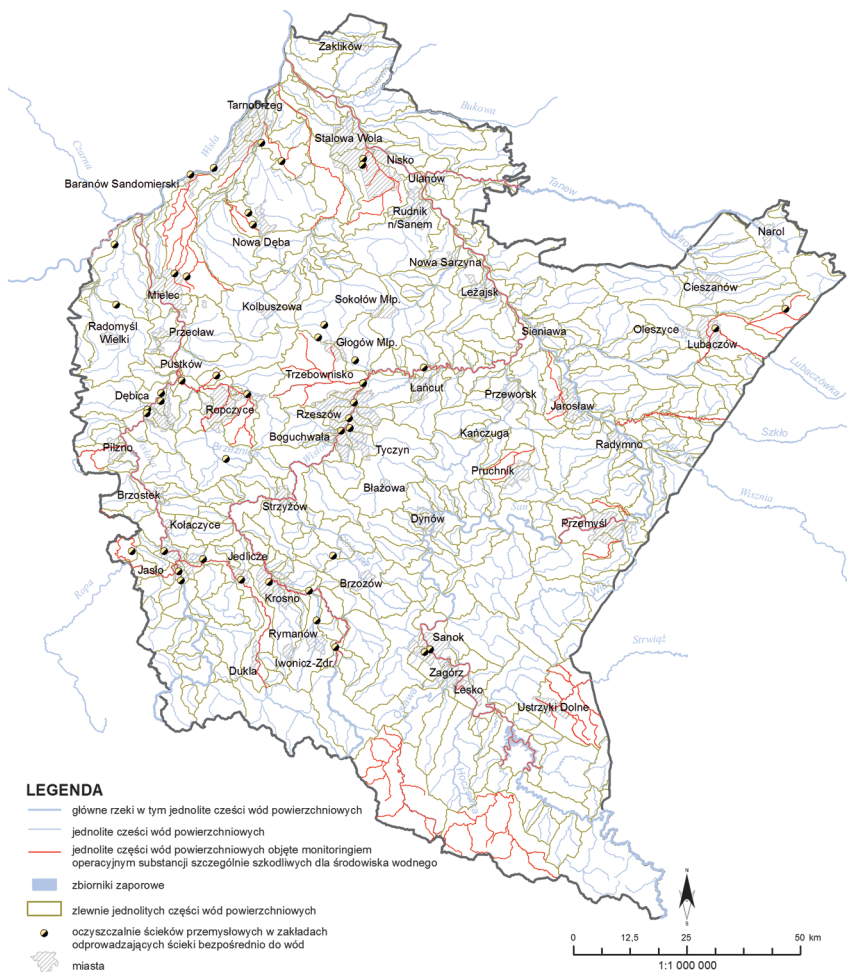
Rys. 3.1.5. Rozmieszczenie głównych oczyszczalni ścieków przemysłowych działających w zakładach odprowadzających ścieki bezpośrednio do wód powierzchniowych własnym systemem kanalizacji, na tle jednolitych części wód powierzchniowych w województwie podkarpackim [51, [151, [161, [201, [271, [361, [391]
