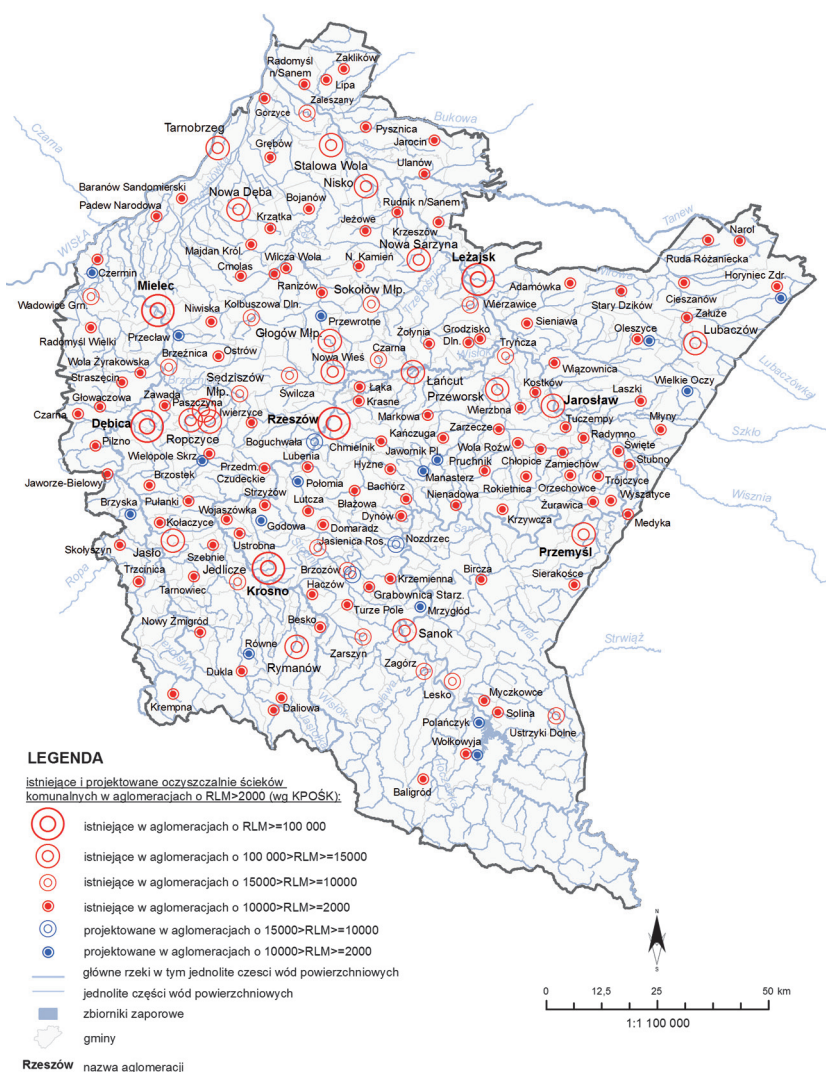
Rys. 3.1.4. Rozmieszczenie oczyszczalni ścieków istniejących oraz projektowanych w aglomeracjach o RLM \geq 2000 na tle jednolitych części wód powierzchniowych w województwie podkarpackim [5], [13], [15], [16], [18], [27], [36]
